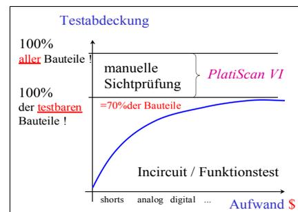
Ziel ist zum einen, beim ICT den Anteil der nicht geprüften Bauteile zu reduzieren und die **Fehler-Abdeckung** deutlich zu **erhöhen** (im In-Circuit- und Funktionstest werden üblicherweise nur 70% aller Bauteile erfasst).
